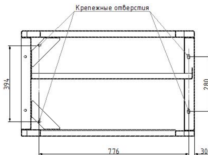
Рис. Б.1. Установка камер на закладные
